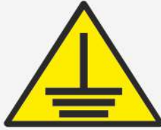
اتصال زمین Grounding
